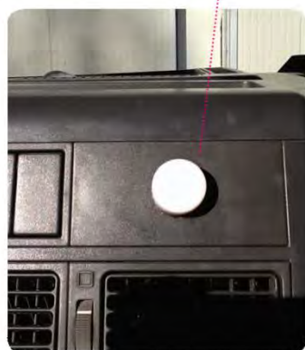
Segnalatore acustico luminoso installato nel cruscotto del veicolo
